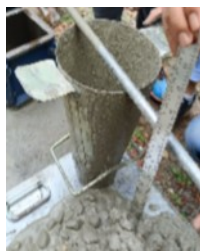
(a) Pengukuran nilai slump adonan segar.
