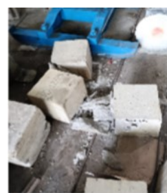
(b) Pola kehancuran beton normal.
