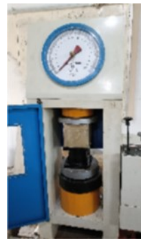
(b) Pembebanan tekan sampai benda uji runtuh.
