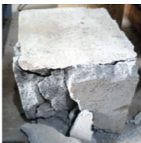
(a) Pola kehancuran beton ringan
