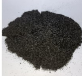
(a) POFA atau abu boiler yang digunakan.
