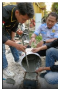
(c) Pemasukan adonan ke dalam cetakan kubus.
