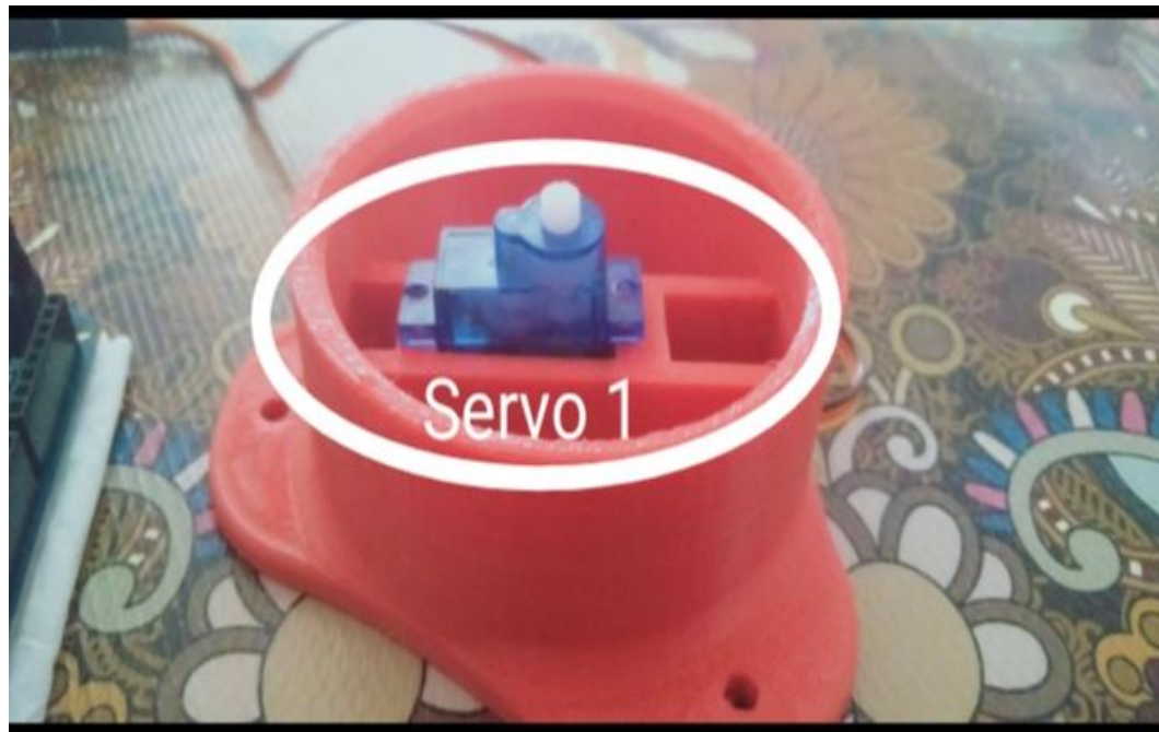
Gambar 3. Motor servo sebagai poros horizontal
