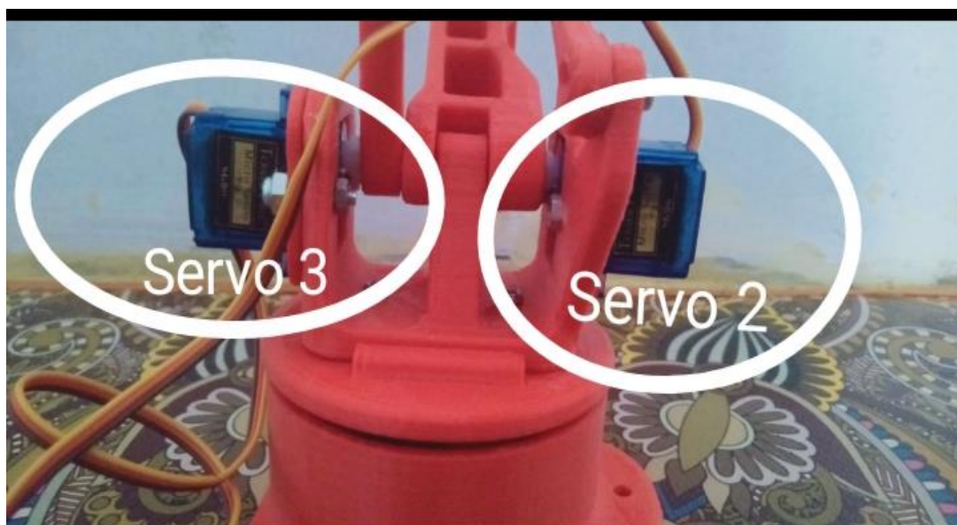
Gambar 4. Motor Servo Sebagai Pengangkat Vertikal
