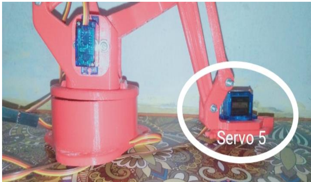
Gambar 5. Motor servo sebagai pencengkram pada Gripper
