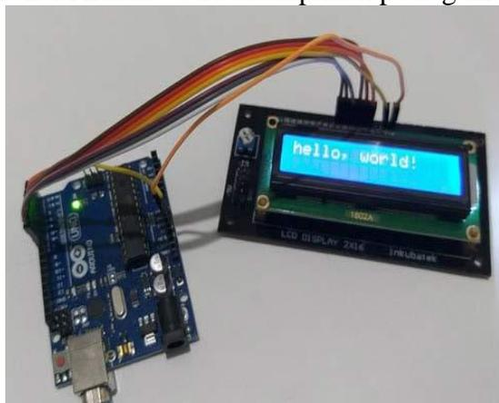
**Gambar 7. Arduino Uno dengan LCD 16x2**
