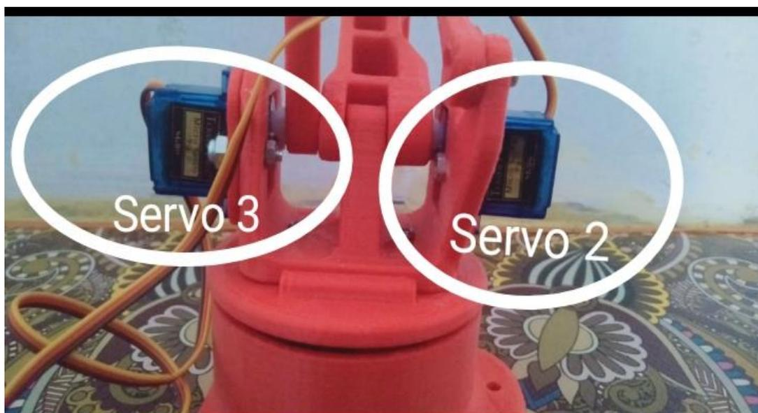
**Gambar 4. Motor Servo Sebagai Pengangkat Vertikal**
