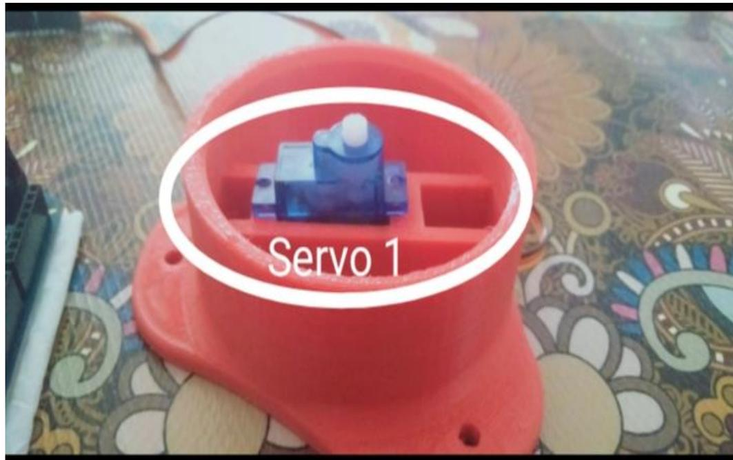
**Gambar 3. Motor servo sebagai poros horizontal**
