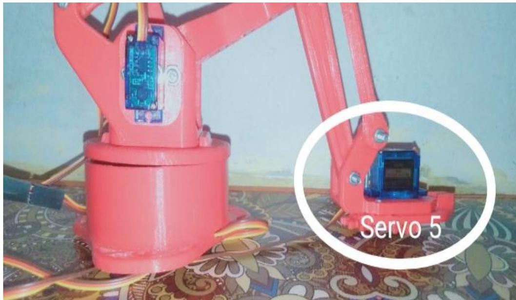
**Gambar 5. Motor servo sebagai pencengkram pada Gripper**
