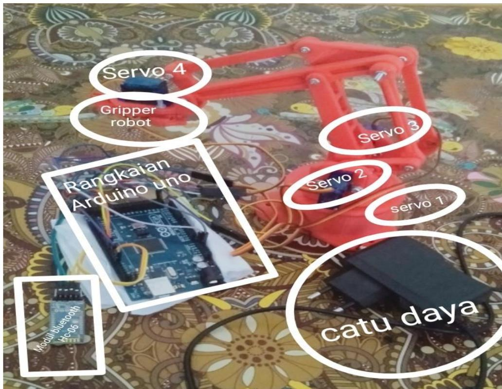
**Gambar 9. Pengujian Sistem Keseluruhan**
