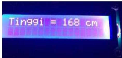
**Gambar 13. Tampilan hasil dari pengukuran tinggi badan pada LCD objek kelima, pengukuran manual 168 cm**
