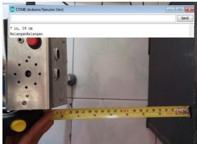
**Gambar 7. Pengujian Sensor pada Jarak 20 cm**
