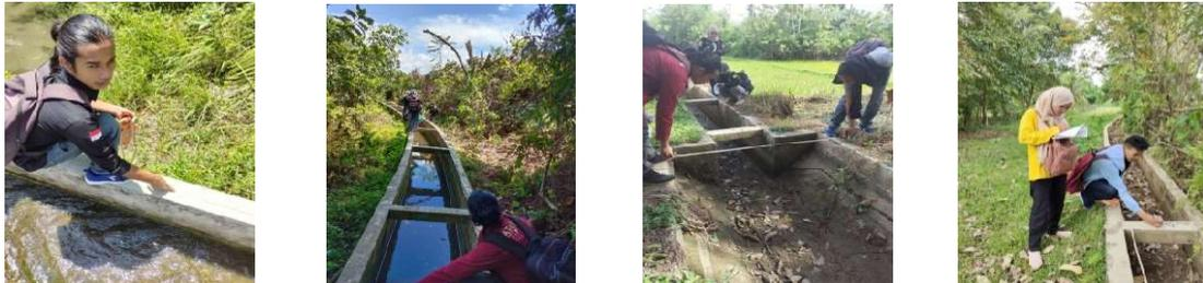
Gambar 4. Pengukuran dimensi saluran dan panjang saluran
