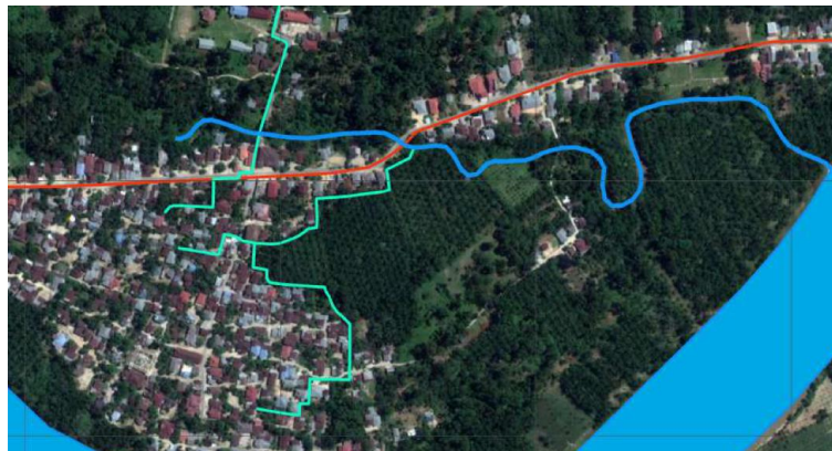
Gambar 4. Jaringan drainase eksisting di Dusun 1 dan Dusun 2
