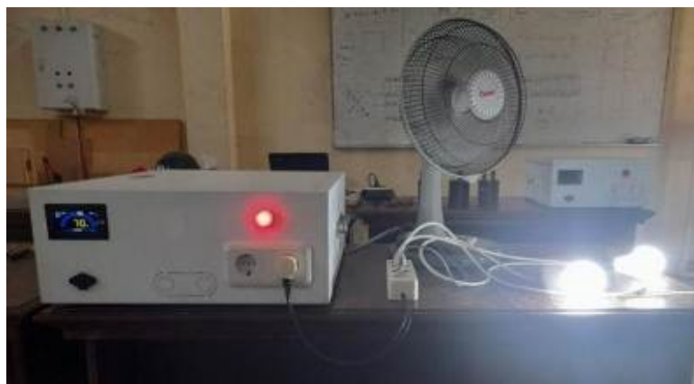
Gambar 8. Pengujian moda discharging sistem STLB
