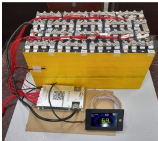
Gambar 5. Baterai-terkemas, lengkap dengan unit BMS dan layar monitor
