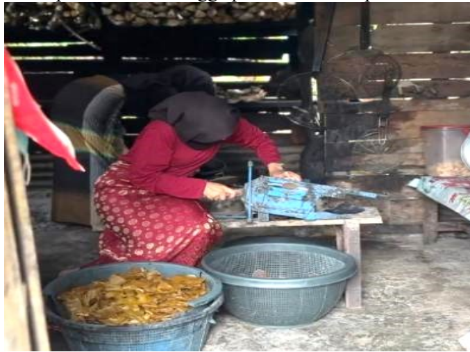
Gambar 2. Proses pencampuran adonan dan pencetakan kerupuk sagu
